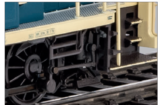
Mit beidseitiger Indusi und beweglichem Antrieb der Spurkranzschmierung
