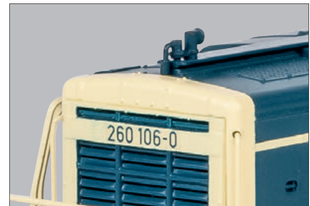
Stirnseite mit Lüftungsgitter und moderner Kühlwasseranzeige mit Anzeigeninstrument auf dem Vorbau
